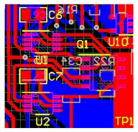
Figure 56. LM74610-Q1 Smart-Reverse Battery-Diode Layout
