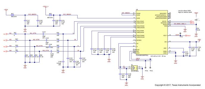
Figure 16. PCM1865-Q1 Circuits—Master PCM1865-Q1
