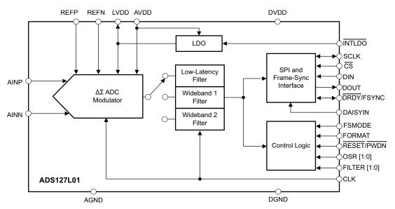
Figure 2. ADS127L01 Block Diagram
