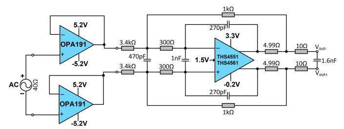
Figure 17. TIDA-01013 AFE Subsystem
