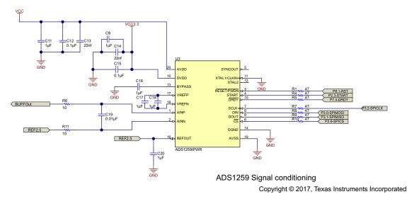
Figure 18. ADS1259-Q1 Schematic
