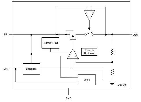
Figure 2. TPS709-Q1 Block Diagram
