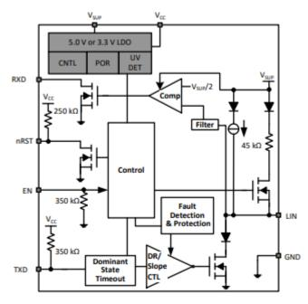
Figure 2-6. TLIN10283-Q1 Block Diagram
