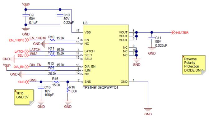
Figure 2-9. TPS1HB16-Q1 Configuration Schematic
