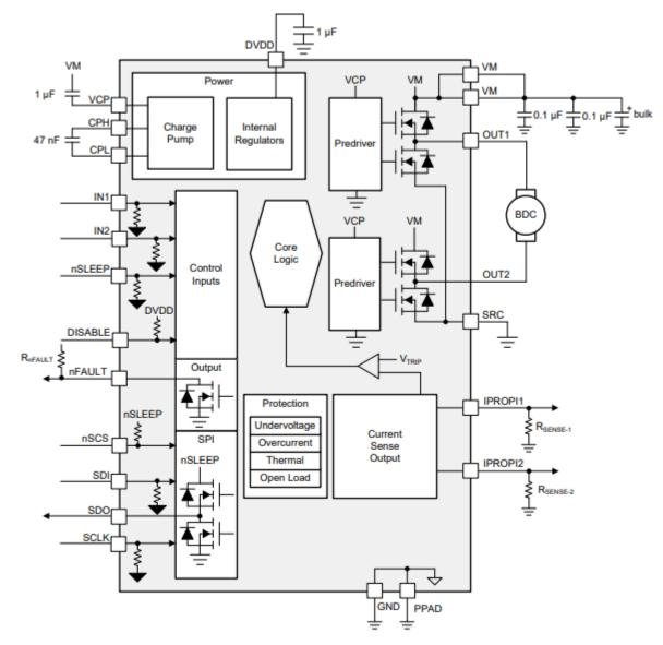
Figure 2-3. DRV8873-Q1 Block Diagram
