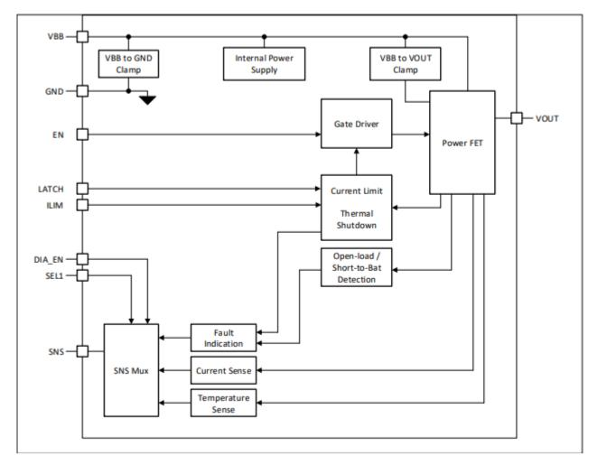
Figure 2-4. TPS1HB16-Q1 Block Diagram
