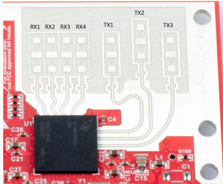
**Figure 3-8. PCB Antennas**
