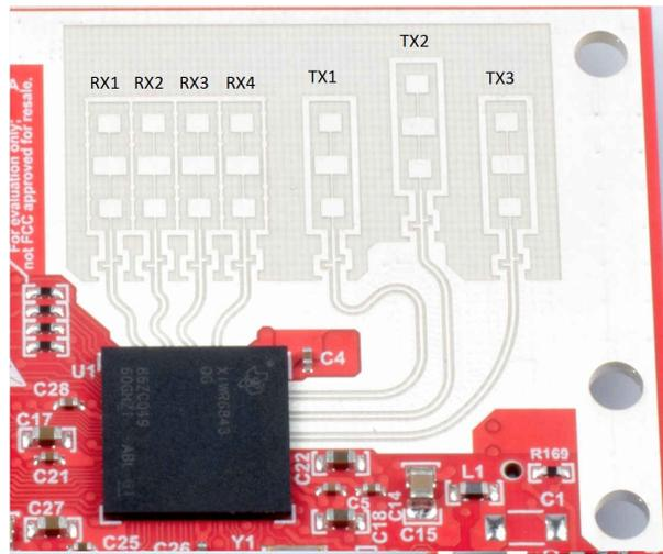
**Figure 6-7. PCB Antennas**
