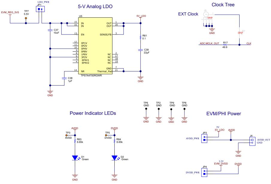
Figure 8-4. ADS1258EVM Power and Clock Circuits
