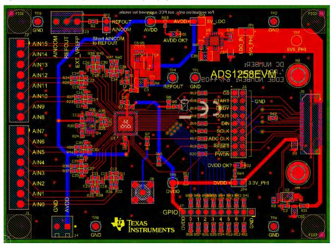
Figure 8-1. ADS1258EVM PCB Layout
