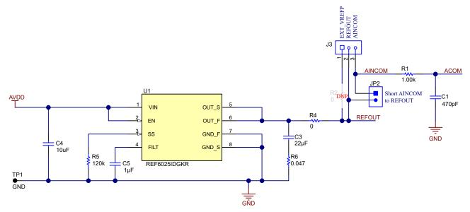
Figure 3-6. ADS1258EVM Voltage Reference Circuit
