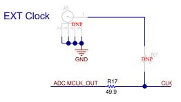
Figure 3-5. ADS1258EVM Clock Circuit
