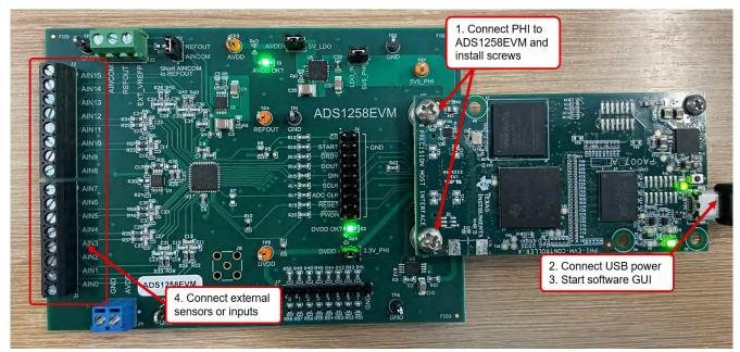
Figure 7-1. ADS1258EVM Hardware Connections
