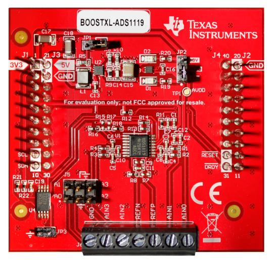
Figure 1. ADS1119 Evaluation Module (BOOSTXL-ADS1119)
