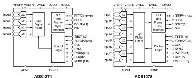
Figure 1-2. ADS1274 and ADS1278 Block Diagram
