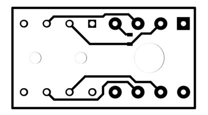
Figure 4-9. PCB Bottom Layer
