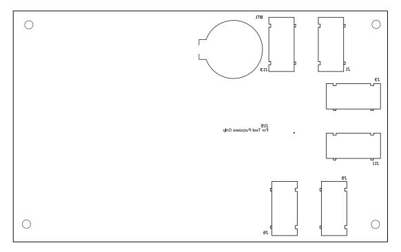
Figure 4-7. Bottom Layer Overlay
