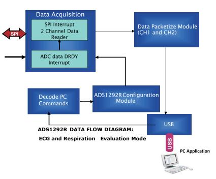
Figure 36. Evaluation Mode Data Flow for ADS1292R
