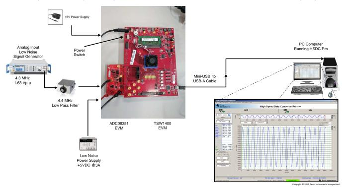
Figure 2. Quick-Start Test Setup
