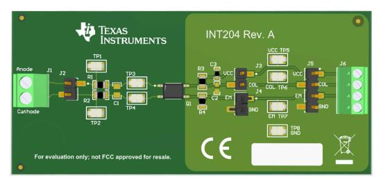
Figure 3-4. ISOM8110DFGEVM PCB 3D Diagram
