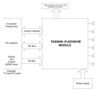
Figure 1-1. Complete PurePath Digital<sup>™</sup> System
