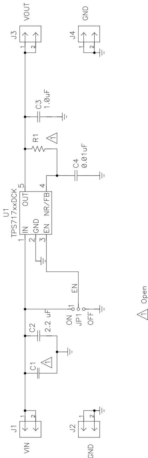
**Figure 4. TPS717xxEVM-134 Schematic**
