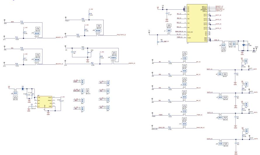
Figure 1. TPS4H160-Q1EVM Schematic
