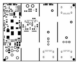
Figure 20. USB-C-PD-TKT-EVM Bottom Solder
