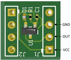
Figure 3-7. Wiring Guide
