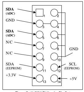
Figure 7: J1 (WV4S) Header Pin Out
