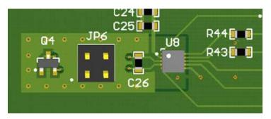
Figure 12. LM96063 Diode Jumper
