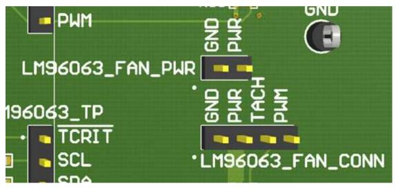
Figure 16. LM96063 Fan Connector
