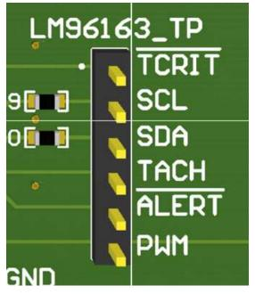
Figure 9. LM96163 Test Points
