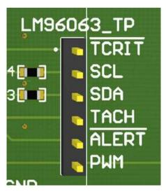
Figure 8. LM96063 Test Points
