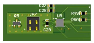
Figure 13. LM96163 Diode Jumper
