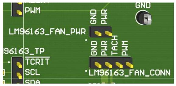
Figure 17. LM96163 Fan Connector
