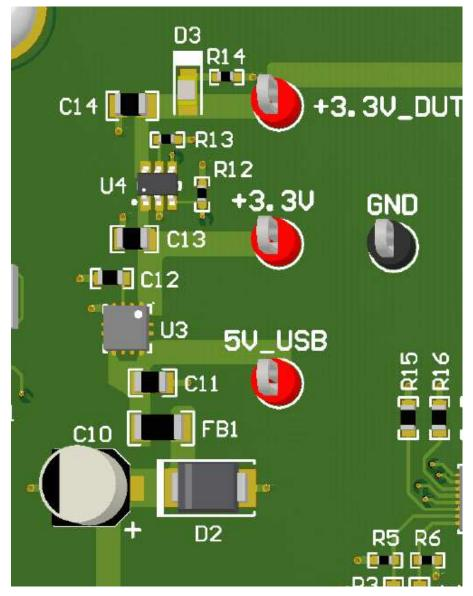
Figure 21. LM63LM64LM96x63 Power Conversion
