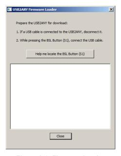
Figure A-2. Firmware Loader
