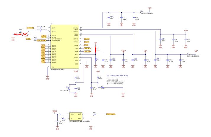
Figure 4-1. DS90UB933-Q1 Serializer
