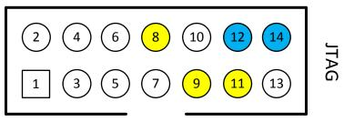
Figure 6. : JTAG Pin Out Diagram
