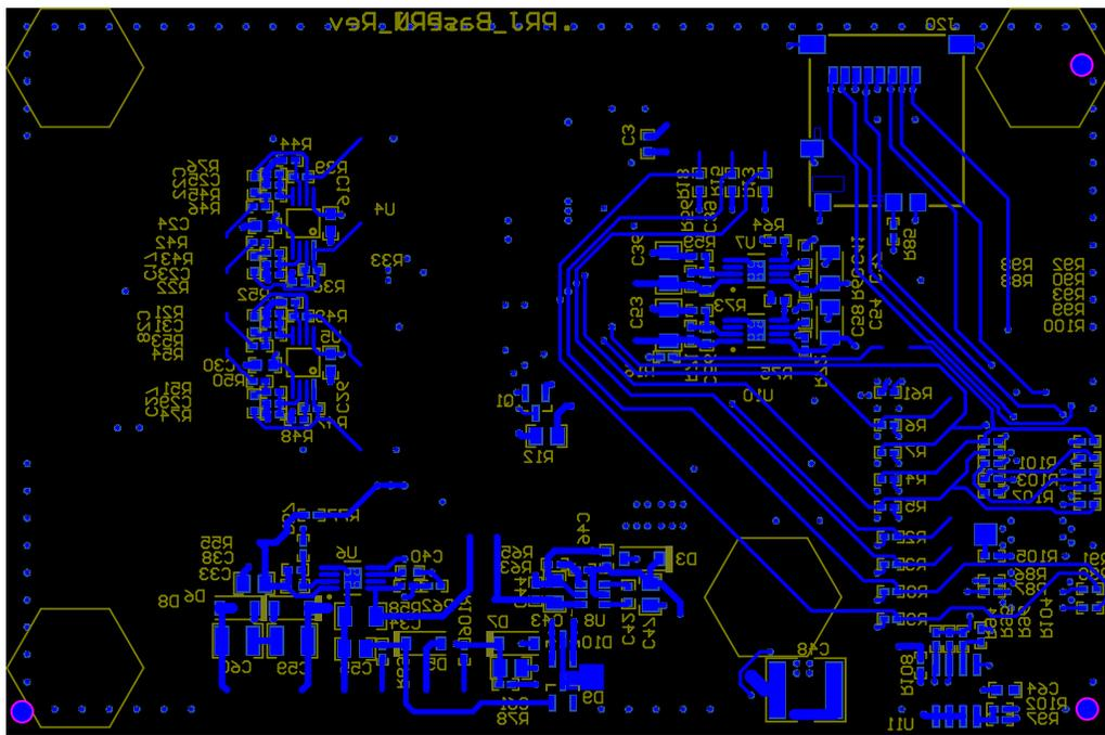
Figure 20. ADS8688EVM Bottom-Side Layout
