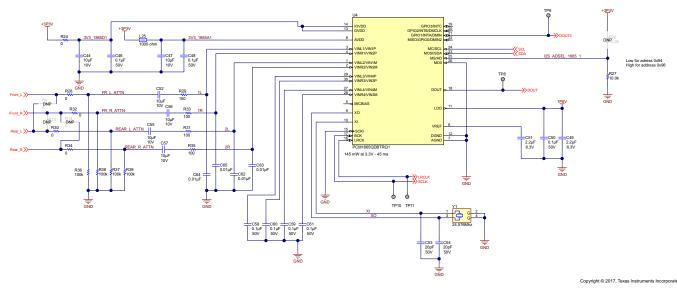
Figure 9. PCM1865-Q1 Circuit
