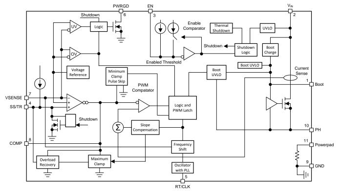
Figure 3. TPS57140-Q1 Block Diagram
