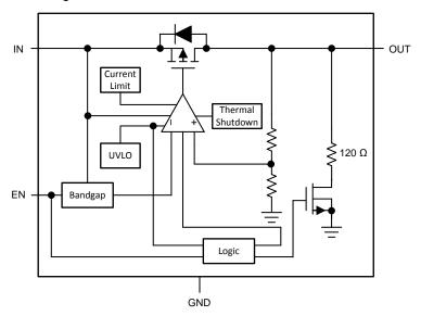
Figure 4. TLV713P-Q1 Block Diagram
