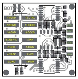
Figure 20. TIDA-01527 Pinout
