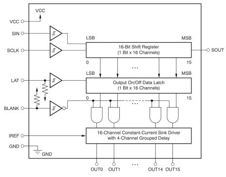
Figure 2-3. TLC59282 Block Diagram
