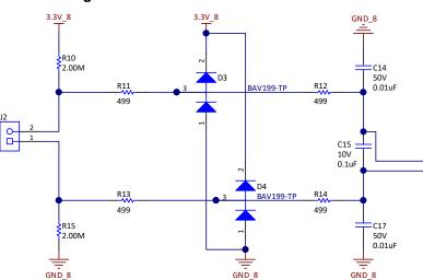
Figure 17. TC Front End with ADS112U04
