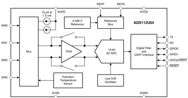
Figure 6. ADS112U04 Functional Block Diagram
