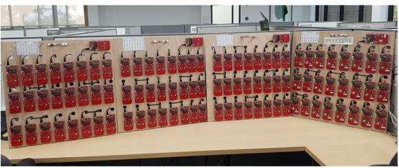
Figure 23. 100-Node Network Test Setup
