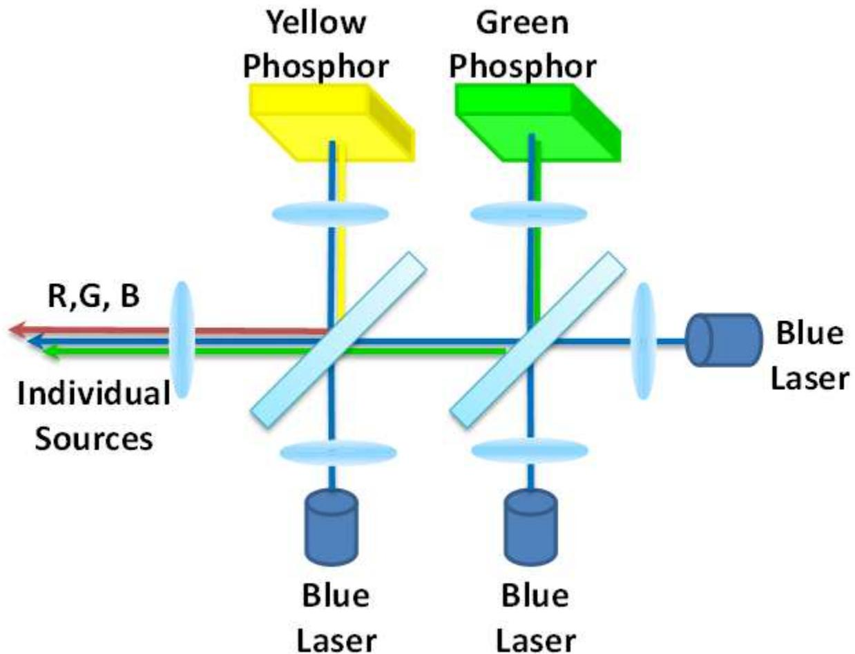
Figure 7. Laser-Phosphor Illumination
