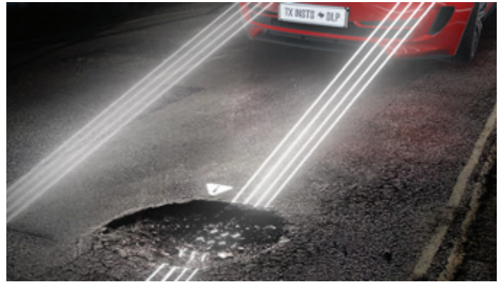
Abbildung 6. DLP-Scheinwerfer in Kombination mit dem Fahrerassistenzkamarasystem können Objekte erkennen und den Fahrer vor Gegenständen auf der Fahrbahn warnen.
