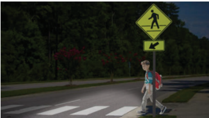
Abbildung 7. DLP-Scheinwerfer beleuchtet ein Kind beim Überqueren der Straße und dimmt gleichzeitig das Licht, welches das Zebrastreifen-Schild beleuchtet, um Blendeffekte zu reduzieren.
