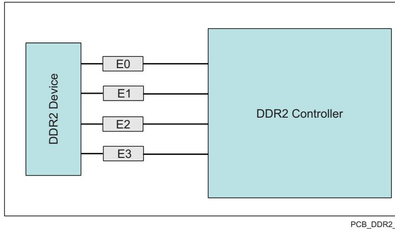
**Figure 7-30. DQS and DQ Routing and Topology**
