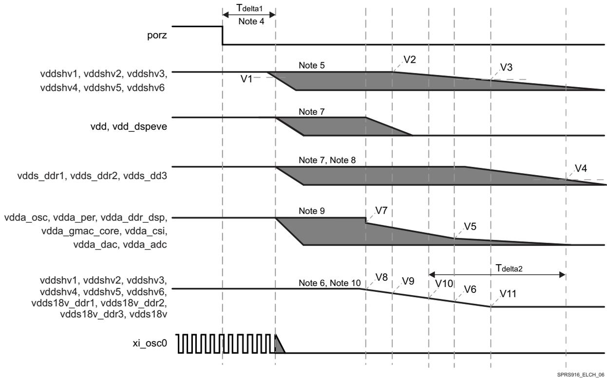
**Figure 5-9. Abrupt Power-Down Sequencing<sup>(1)</sup>**
