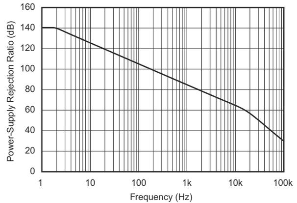
$V_S = 5\text{ V} + 250\text{-mV sine disturbance}$
