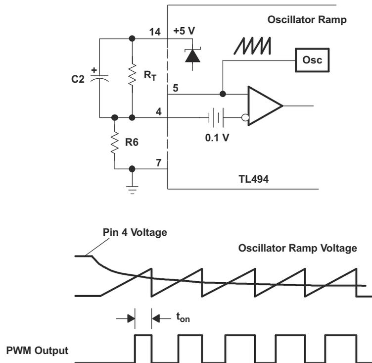
**Figure 10-5. Soft-Start Circuit**
