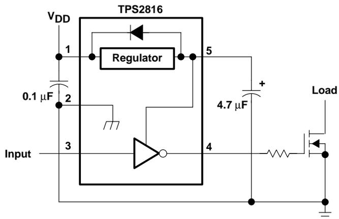
Figure 21.  $V_{CC} > 14 V$
