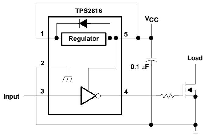
Figure 20.  $V_{CC} < 14 V$
