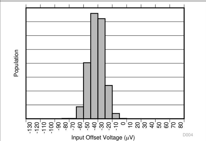
Figure 6-4. Input Offset Voltage Production Distribution A4
