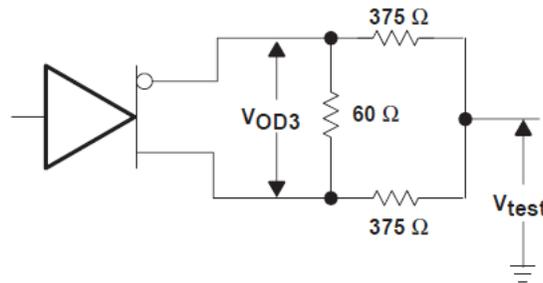
Figure 6-2. Driver  $V_{OD3}$
