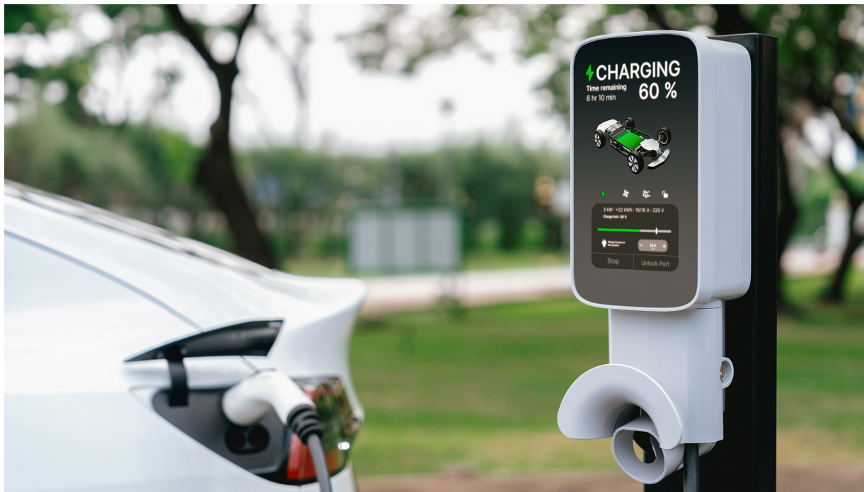
图 3. 具備 ALS 功能的 EV 充電站，可用於竄改偵測和亮度調整
