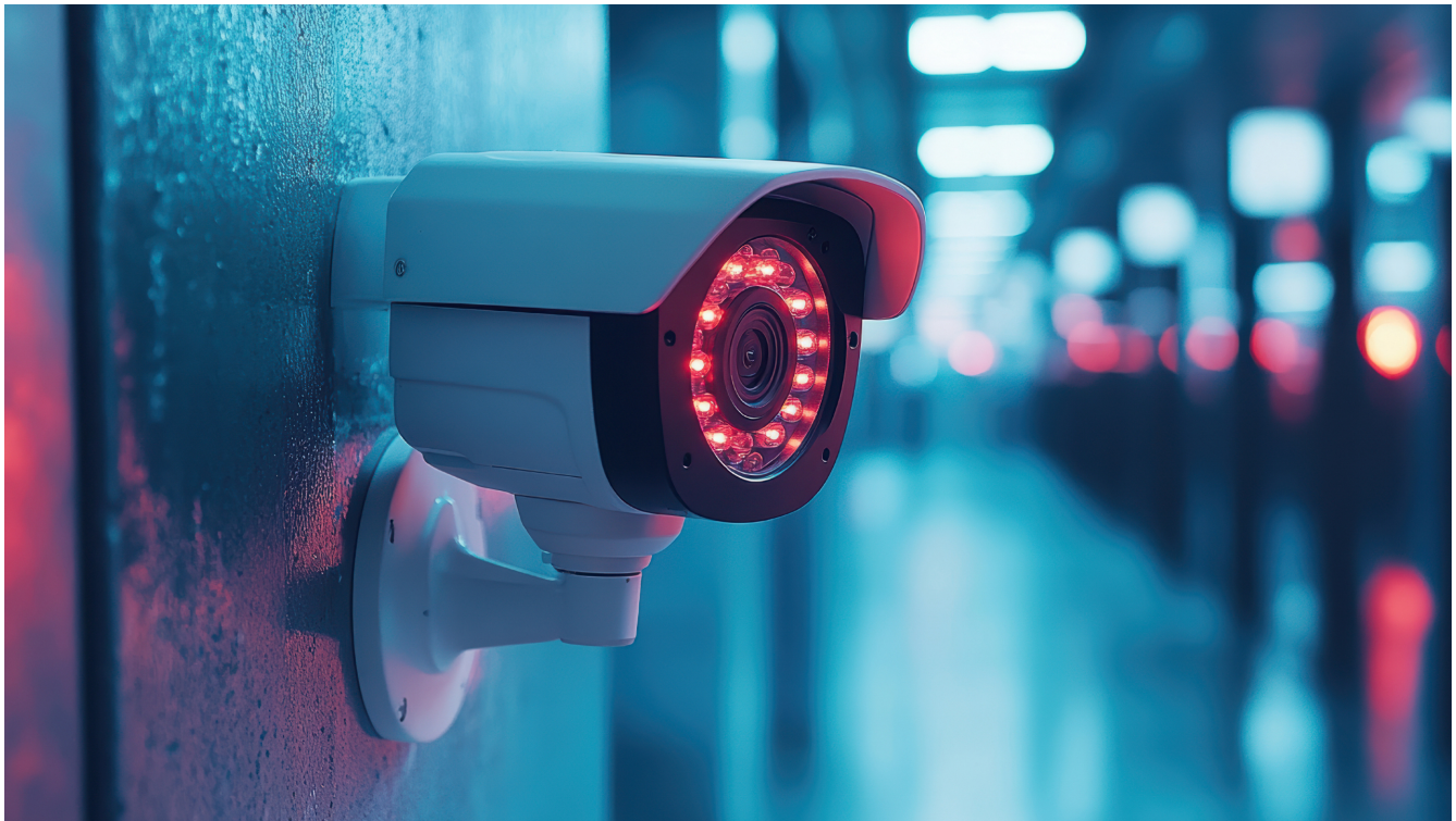
圖 1. 使用環境光感測器和紅外線 LED 的網際網路協議網路攝影機
