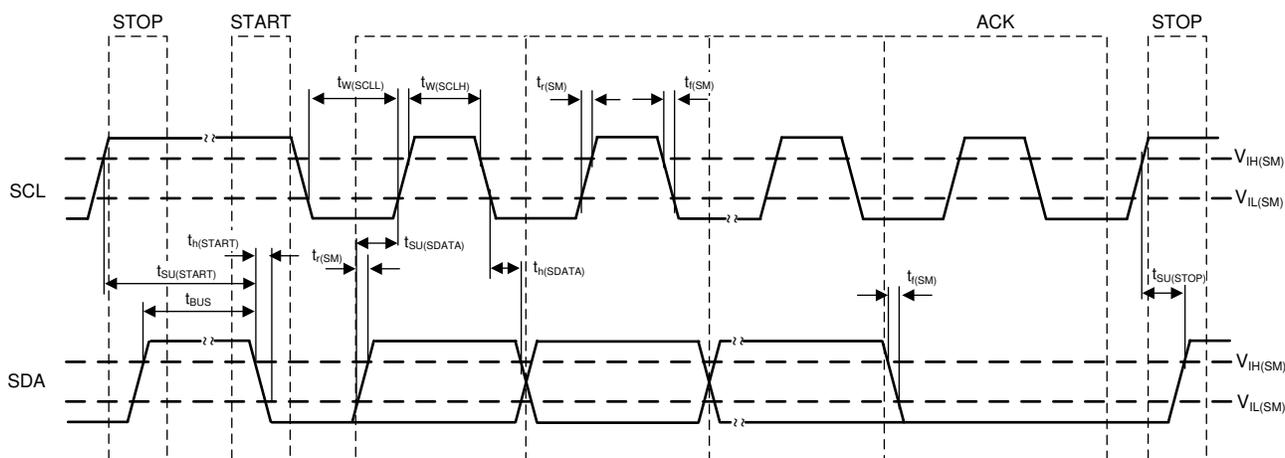
**Figure 8-9. I<sup>2</sup>C Timing Diagram**
