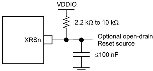
**Figure 6-5. Reset Circuit**
