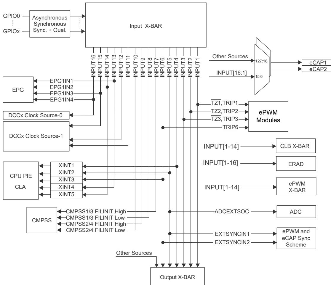
**Figure 5-6. Input X-BAR**
